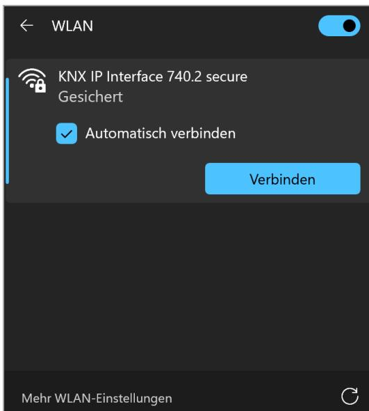
Da das KNX IP Interface 740.2 *wireless secure* einen DHCP-Server integriert hat, sollte die IP Adresse des PCs automatisch (DHCP) eingestellt werden. Bei den meisten Laptops ist dies die Standardeinstellung.
