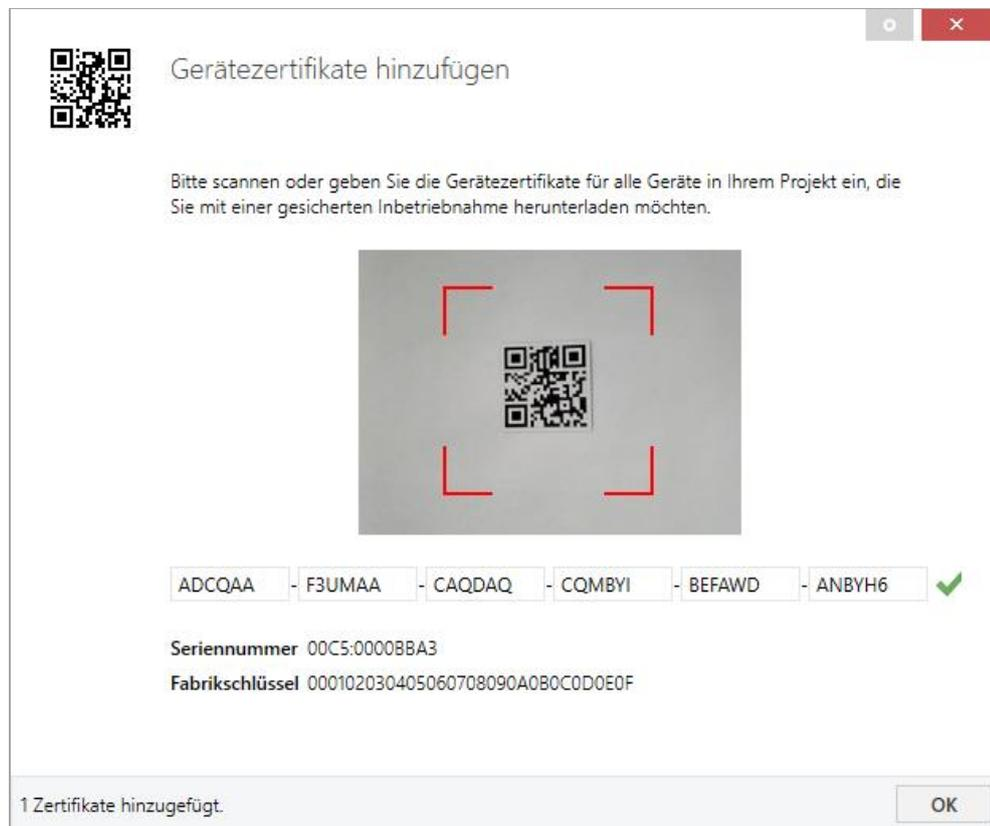
Das Zertifikat ist als Text auf dem Gerät aufgedruckt. Es kann auch über eine Webcam vom aufgedruckten QR-Code abgescannt werden.
