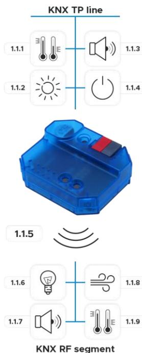
Die physikalische Adresse des KNX RF/TP Coupler 673.1 *secure* entspricht der Form x.y.z (x, y: 1 ... 15, z: 1 ... 255). Somit funktioniert das Gerät als Segmentkoppler.
