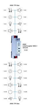
Die physikalische Adresse des KNX LineCoupler 650.1 *secure* entspricht der Form x.y.z (x, y: 1 ... 15, z: 1 ... 255). Somit funktioniert das Gerät als Repeater bzw. Linienverstärker.
