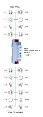
Die physikalische Adresse des KNX LineCoupler 650.1 *secure* entspricht der Form x.y.z (x, y: 1 ... 15, z: 1 ... 255). Somit funktioniert das Gerät als Segmentkoppler.
