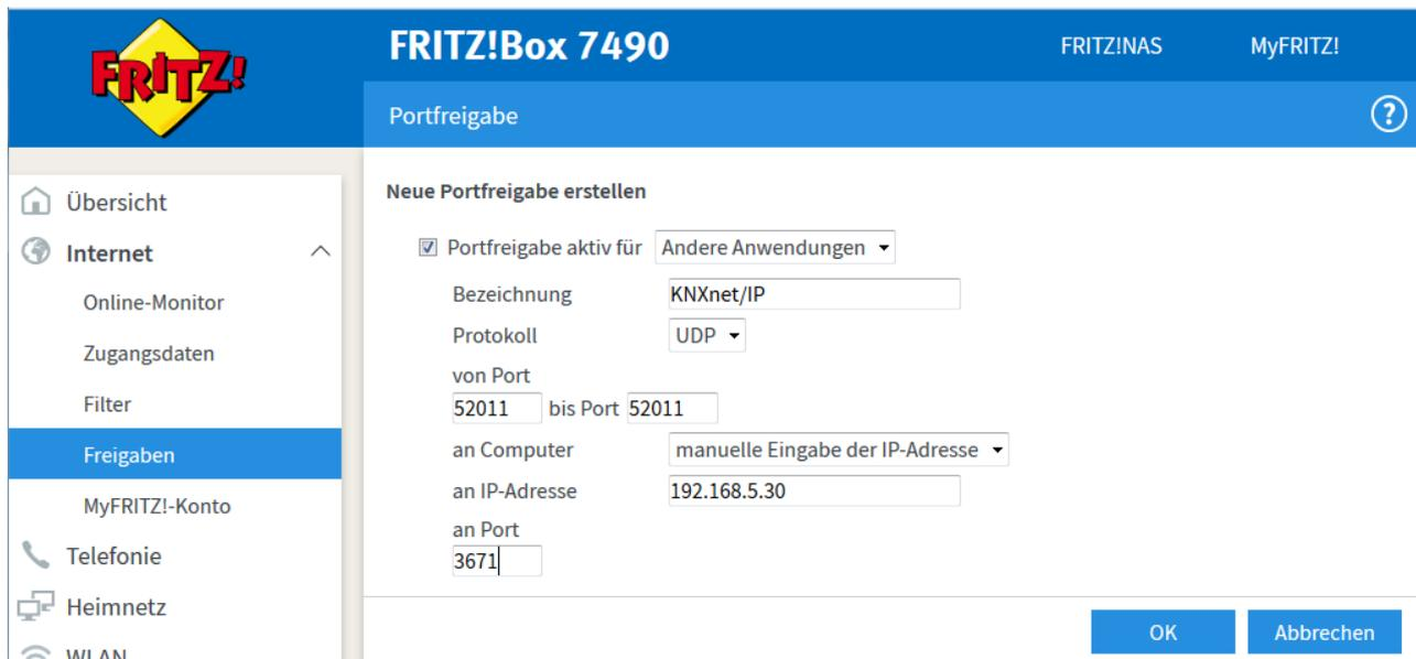
Abbildung 2: Einstellungen im DSL-Router (Portfreigabe für KNXnet/IP)
