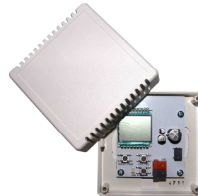
Abb. 2: KNX RF/TP Koppler 670 geöffnet
