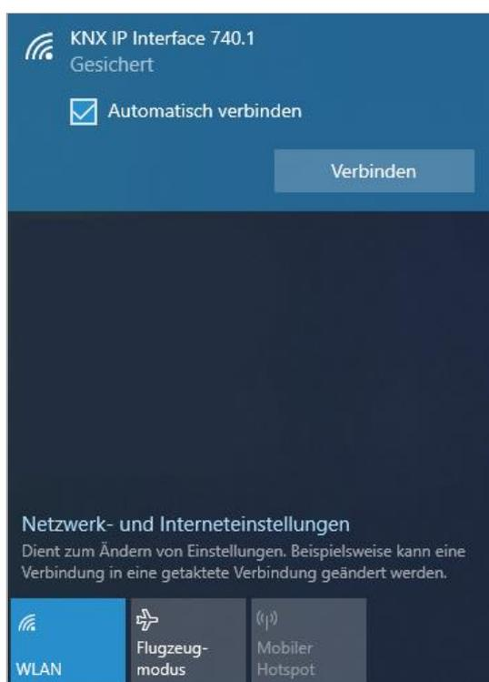
Da das KNX IP Interface 740.1 *wireless* einen DHCP-Server integriert hat, sollte die IP Adresse des PCs automatisch (DHCP) eingestellt werden. Bei den meisten Laptops ist dies die Standardeinstellung.
